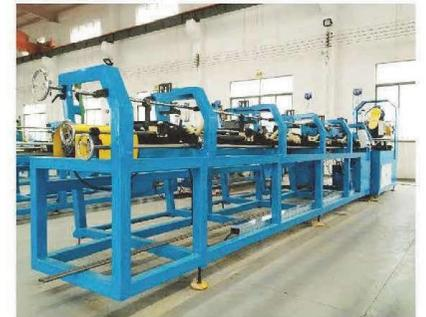
全自动切管去毛刺弯管数控生产线含全自动上料架、全自动切管机、去毛刺机、输送排料架、机器人、数控弯管机、自动码垛（落料系统）。
