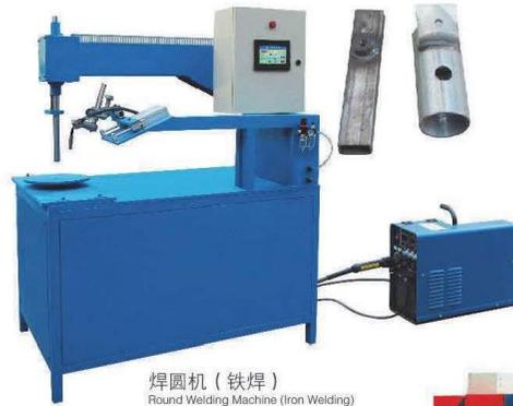
焊圆机 (铁焊)
